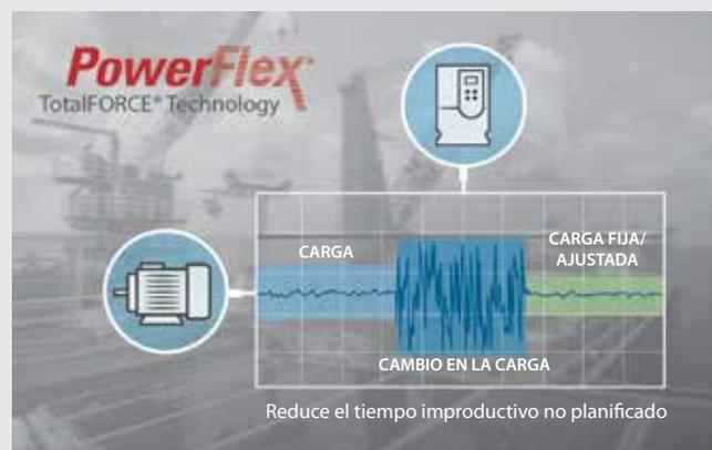
La ilustración muestra una combinación de ajuste adaptativo y observador de carga en una aplicación de control de motores.
