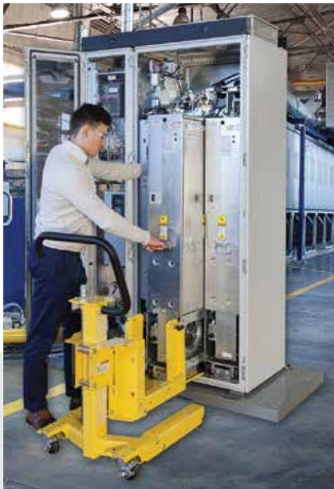
**El diseño rodante** facilita la instalación y el mantenimiento del variador, ya que permite retirar por completo un módulo del gabinete, dejando un amplio espacio detrás del variador para el cableado. **Los cables de alimentación** pueden permanecer conectados cuando la unidad se saca del gabinete.
