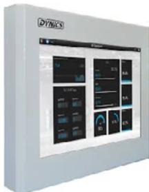
Dynics HSW es una estación de trabajo completamente sellada con clasificación IP66, diseñada para resistir agua y contaminantes ambientales. Equipada con un procesador de cuatro núcleos Apollo Lake o Whiskey Lake, es ideal para aplicaciones de grado alimenticio en entornos cáusticos. Incluye una pantalla táctil superpuesta, acero inoxidable 316 de grado alimenticio NEMA 4X, y un sistema de montaje con soporte de pared/VESA con inclinación de hasta 20°.
