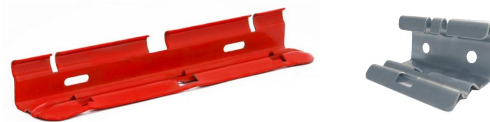
El Clip Automático se puede instalar a presión o con la ayuda de un desarmador introduciendo el mismo en el orificio de la junta y girar hasta el enganche en el fondo de la charola.
