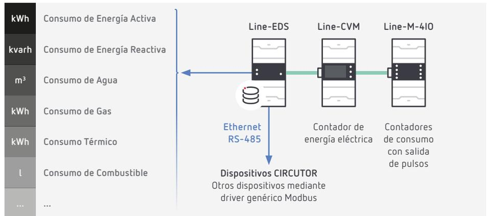
El software SGEi integrado en **Line-EDS** te permite realizar pantallas SCADA para conocer, en tiempo real, dónde, cómo, cuándo y cuánta energía consume tu instalación. Esta información te permite ahorrar en costes económicos y realizar una gestión global acorde con la ISO 50 001.
