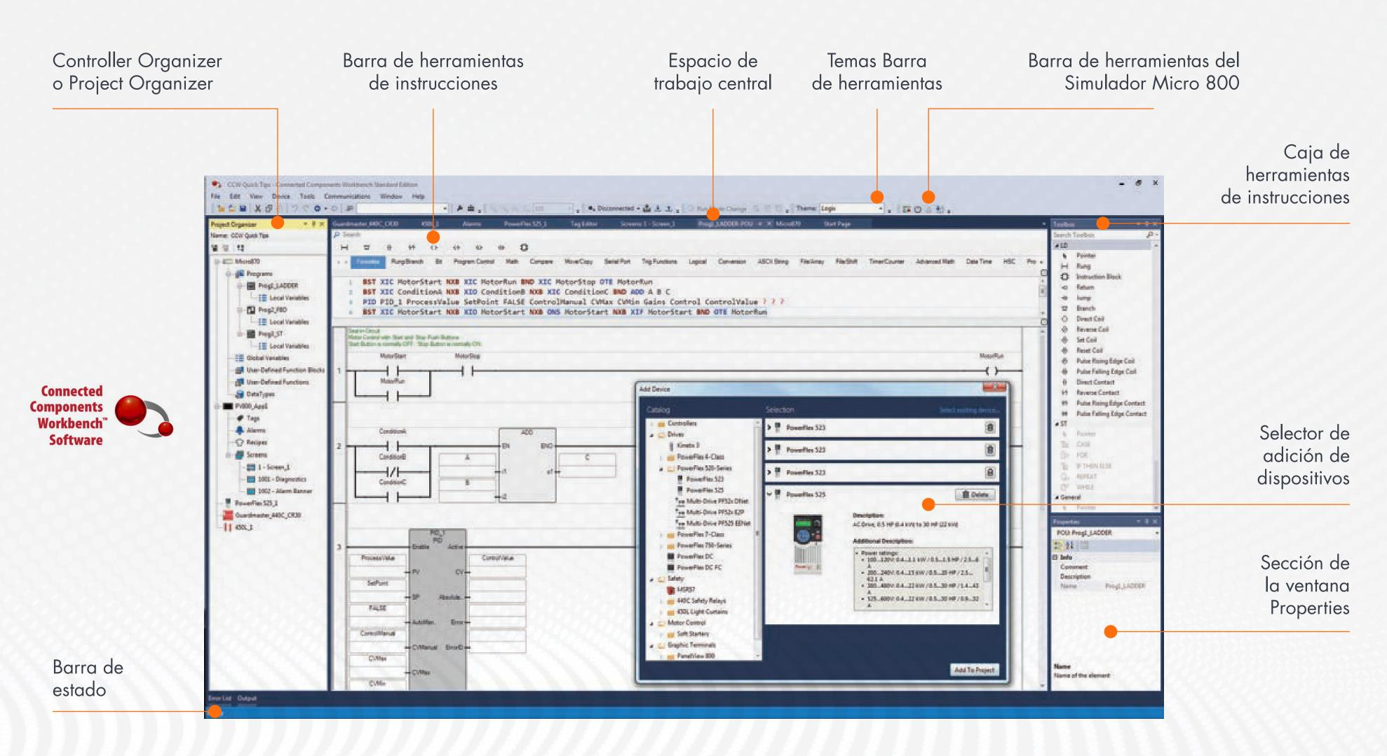
Un solo software para configuración de dispositivos, programación de controladores e integración con el editor interfaz hombre-máquina (HMI) a la vez que reduce el tiempo y costo de desarrollo inicial de la máquina.
